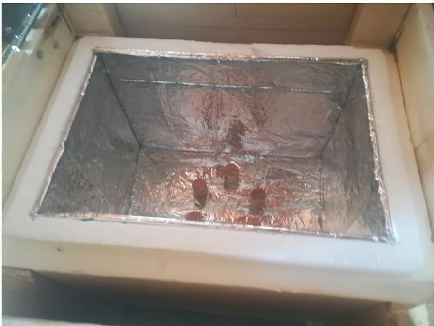
FIGURE 16 – Marmite norvégienne avec caisson d'isolation en polystyrène. Auteur : Rémi Jouët-Pastré.
