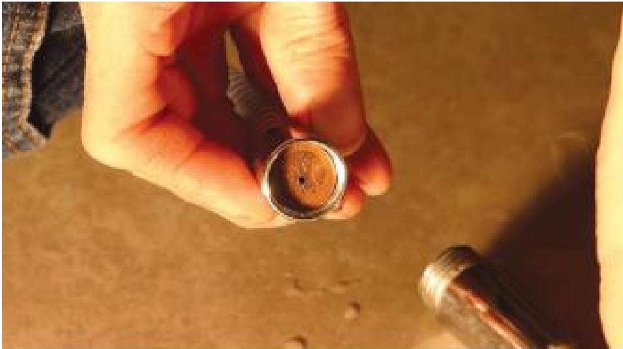
FIGURE 3 – Photo du réducteur de débit d'eau. Source : Low-Tech Lab.
